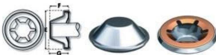
Стандартный высокий осевой колпачок изготовлен из электрооцинкованной стали и обеспечивает максимально возможное проникновение стержня сквозь фиксатор из всех типов колпачков. Высокий осевой колпачок был изначально разработан, чтобы скрывать зажимающие стержень зубчики конкретной модели - самовыравнивающегося фиксатора Starlock, но используется и в других случаях, требующих максимального проникновения стержня.
